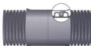
Spajanje cevi sa naglavkom
